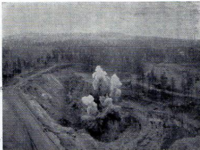
Ett »storskott» i dagbrottet i Kristineberg . 11 cirka 15 m djupa borrhål laddades med i det närmaste 1 ton dynamit. 7000 à 8000 ton gråberg lössprängdes.
